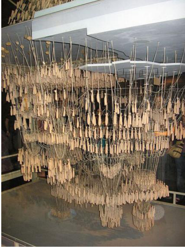
Figura 6. Maqueta de hilos suspendidos, sometidos a la carga de bolsitas cargadas con arena. Fuente: https://es.wikipedia.org/wiki/Archivo:Maqueta_funicular.jpg
