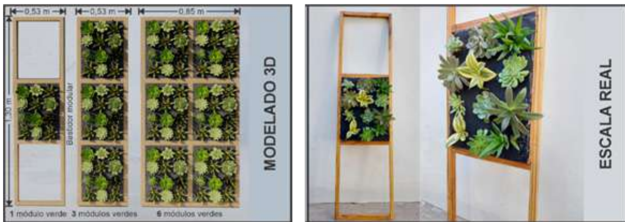
Figura 1. Sistema plantAR y su coordinación modular. Fuente: Elaboración propia.
